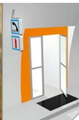
▲ Les niches de sécurité permettront une liaison de qualité avec le PC sécurité.
