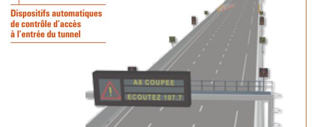
Séquence de contrôle d'accès en amont du tunnel
